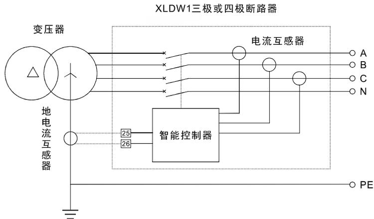
(3P+N) W型外接地电流互感器
