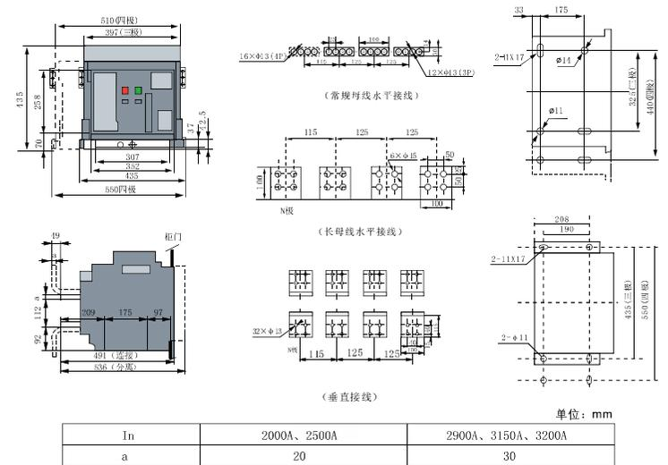
图11 抽屉式断路器安装尺寸及外形尺寸
