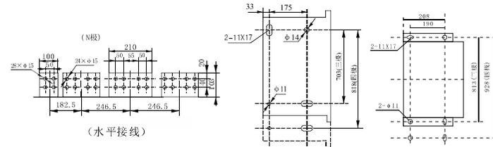
图14 抽屉式断路器安装尺寸及外形尺寸 (XLDW1-6300、6300/4 In=4000A、5000A)
