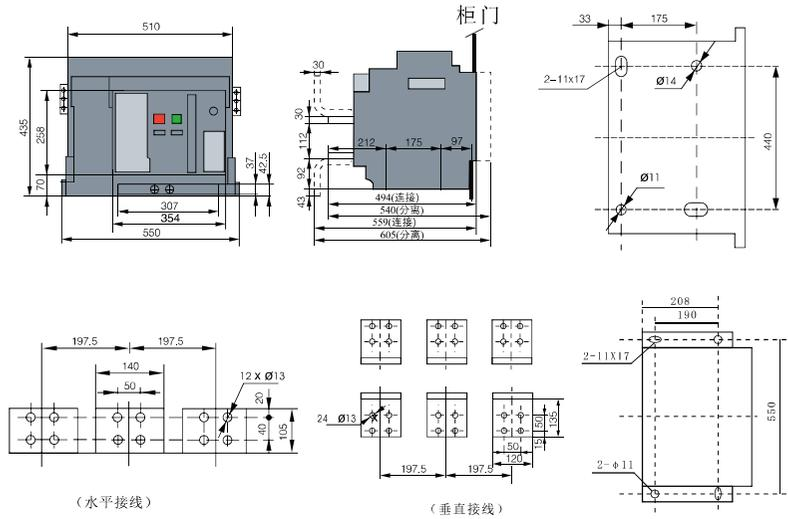
图12 抽屉式断路器安装尺寸及外形尺寸 (XLDW1-4000)
