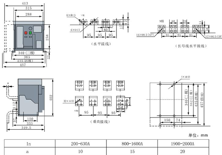
图8 固定式断路器安装尺寸及外形尺寸 (XLDW1-2000、2000/4)
