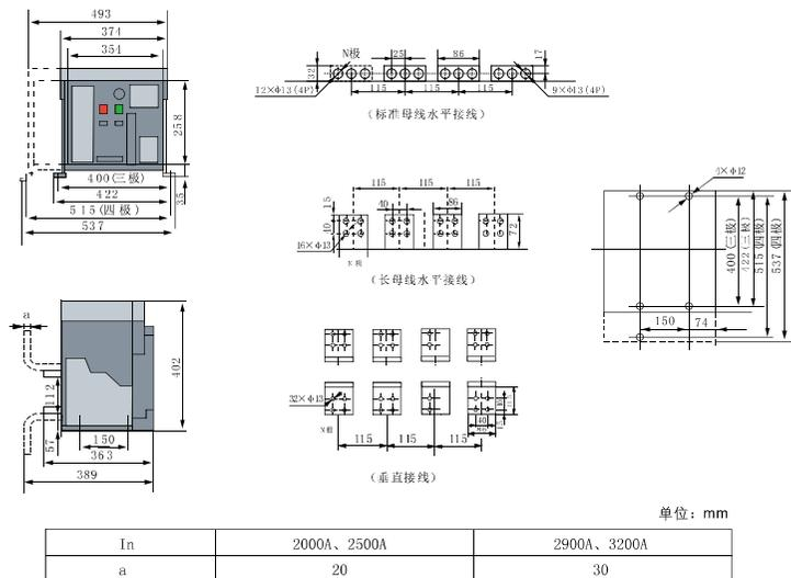
图9 固定式断路器安装尺寸及外形尺寸 (XLDW1-3200、3200/4)
