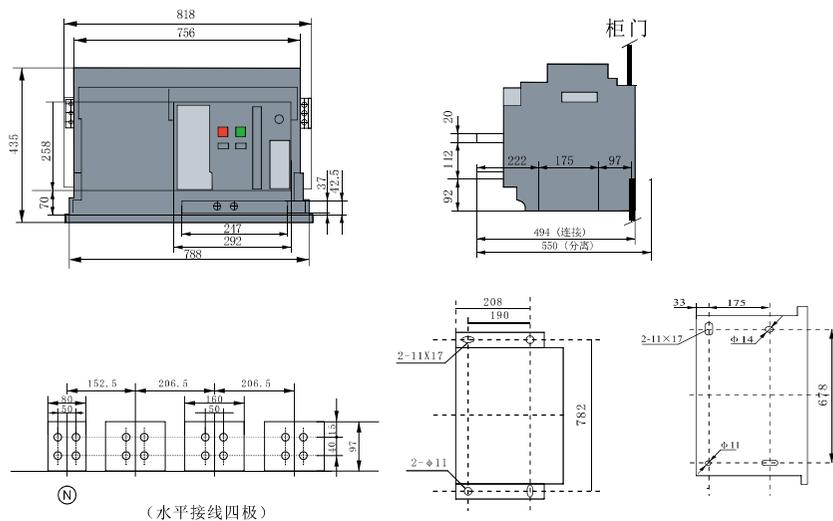
图13 抽屉式断路器安装尺寸及外形尺寸 (XLDW1-4000/4)
