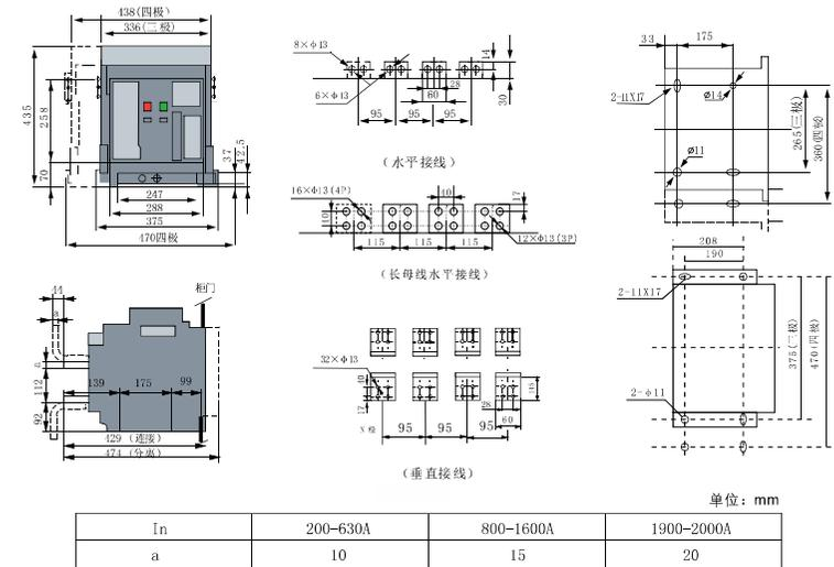
图10 抽屉式断路器安装尺寸及外形尺寸
