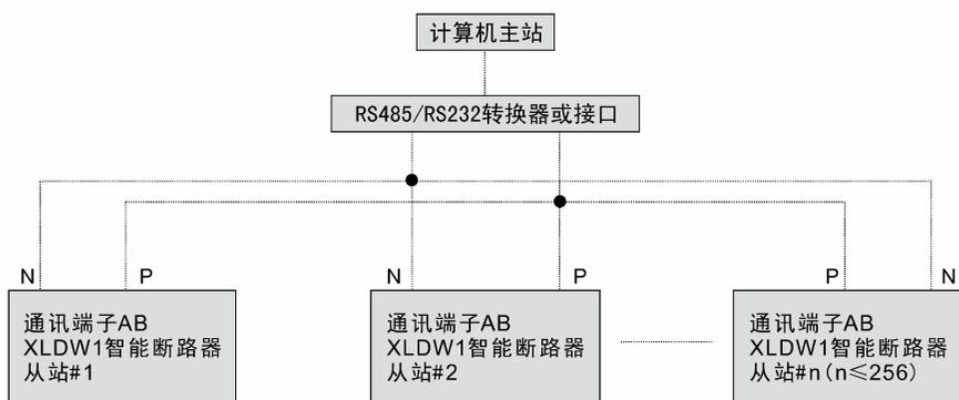
基于通用DP协议的断路器产品的连接关系图如下：
