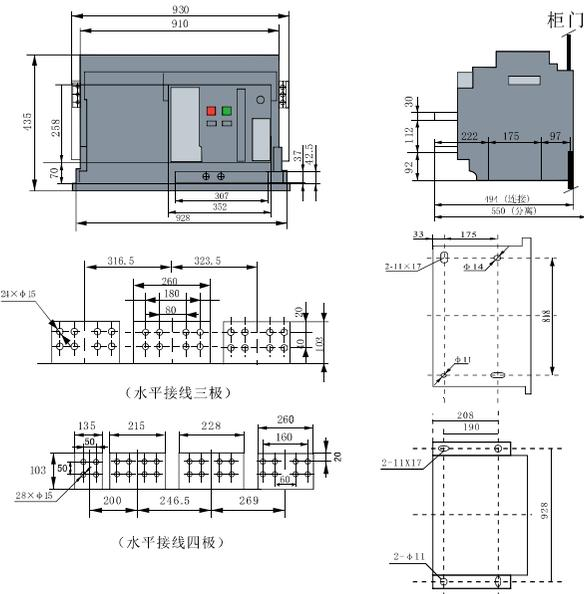
图15 抽屉式断路器安装尺寸及外形尺寸 (XLDW1-6300 In=6300A)
