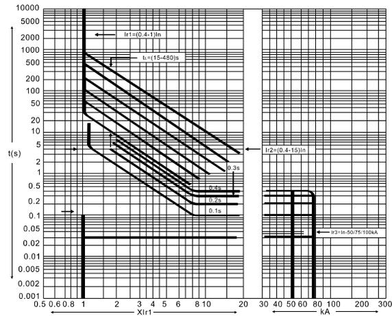
图1 过电流脱扣保护特性曲线
