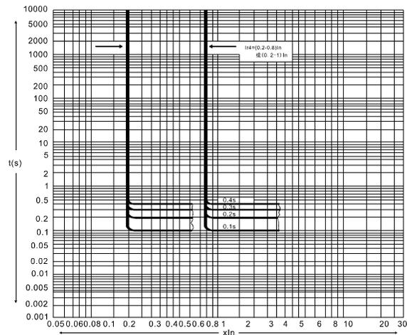
图2 接地故障保护特性曲线
